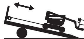
Utilice siempre un cabrestante para cargar y descargar la máquina del vehículo de transporte.
