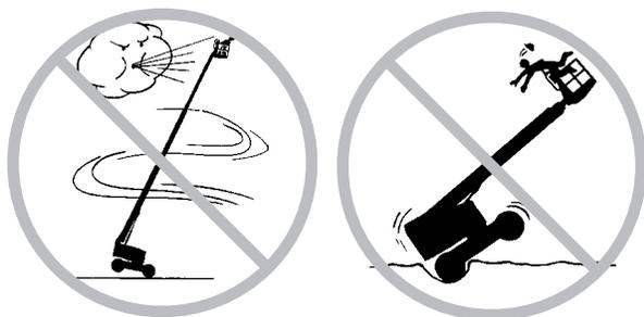
Cuando conduzca la máquina en posición replegada a través de terrenos irregulares, escombros, superficies inestables o deslizantes, o cerca de agujeros y pendientes, extreme las medidas de precaución y conduzca a baja velocidad.
